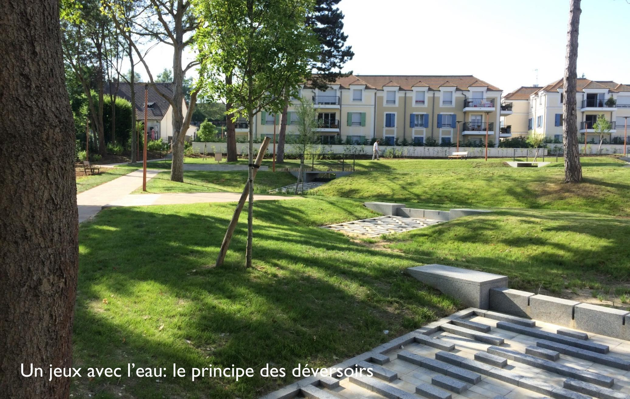
Un jeu avec l'eau: le principe des déversoirs
