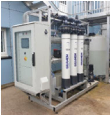
Pilote d'ultrafiltration tertiaire des eaux usées
