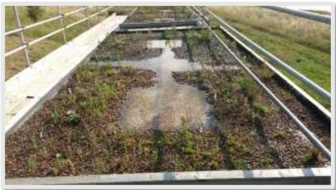
*Expérience d'un toit vert à zone humide éphémère après une pluie estivale. L'image montre l'effet de la manipulation de la dynamique hydrologique des toits avec la formation de flaques d'eau sur le toit vert au premier plan et l'absence de flaque sur le toit en arrière-plan. Barking Riverside, London, UK. (©UJEL SRI)*
