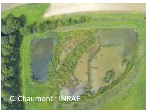
En 2010, quatre zones humides tampons artificielles ont été créées dans un bassin-versant agricole de 355 ha. Elles ont été instrumentées pour suivre dans le temps leur effet sur les flux polluants. Les quatre zones humides représentent 0,2% de la surface totale du bassin drainé.
