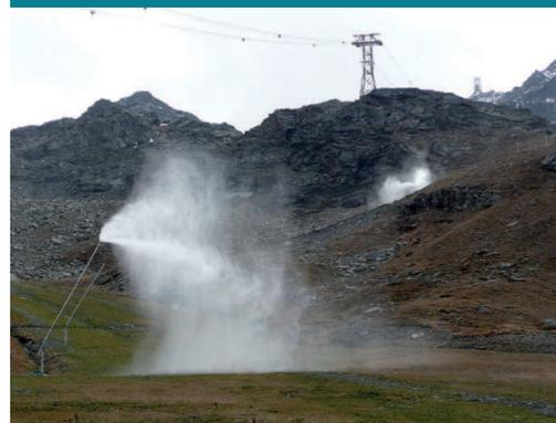
*Production de neige artificielle à des températures supérieures à  $-3^{\circ}\text{C}$*
