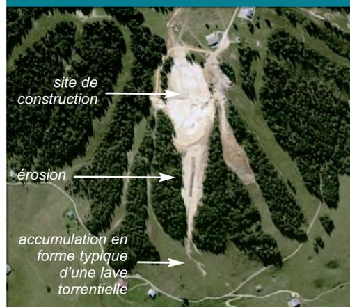
Construction d'une retenue collinaire au Mont Lachat (Crest-Voland) avec signes d'érosion dangereuse et rapide du site d'excavation en 2006
