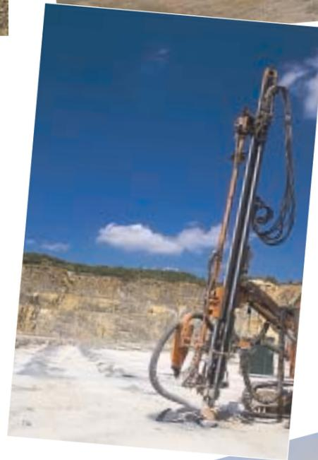
Carrière de granulats éruptifs. Forage des trous en vue d'un tir de mine
