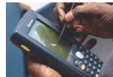
Le télérelevé est une technique permettant de surveiller et de relever à distance les compteurs d'eau de manière automatisée et continue.
