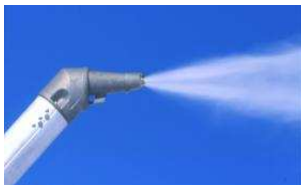
Figure 2 : Principe de l'enneigreur bi-fluide haute pression à mélange interne
