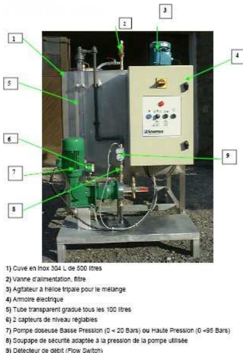
Figure 3 : Descriptif du dispositif de dilution et d'injection du Snomax® dans le système d'enneigement
