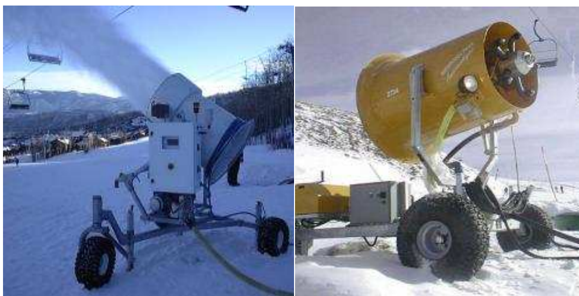
Figure 1 : Photographies d'enneigeurs monofluides basse pression
