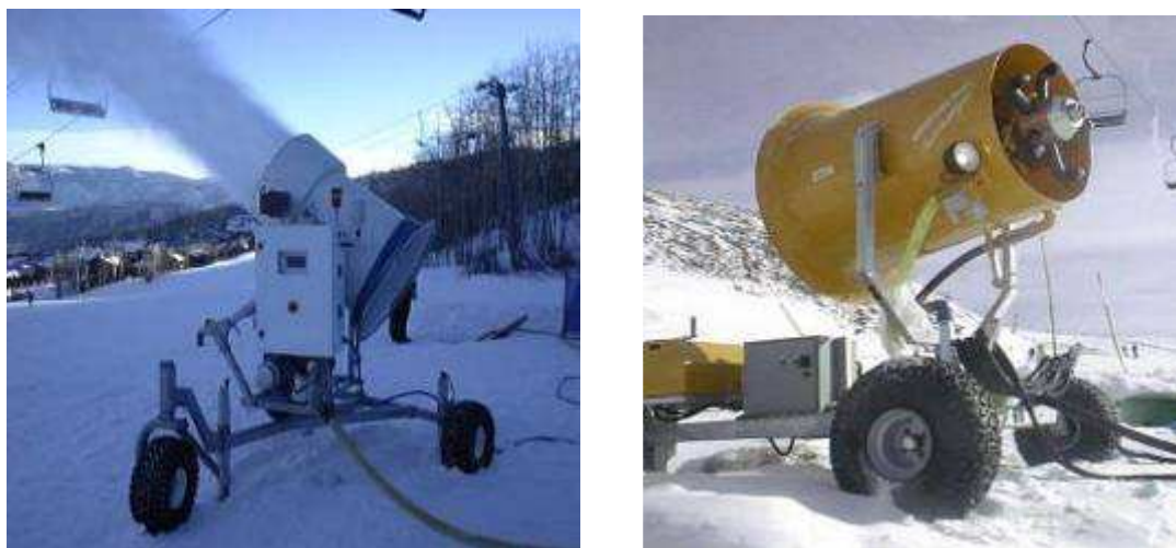
Figure D : photographies d'un enneigreur multigicleur (à gauche) et de l'enneigreur monobuse (à droite) ( http://www.anpnc.com/ )
