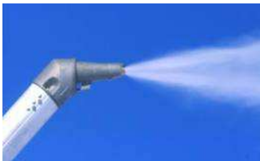
Figure E : Tête productrice enneigreur bi-fluide (source : http://www.anpnc.com/ )
