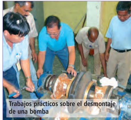
Trabajos prácticos sobre el desmontaje de una bomba
