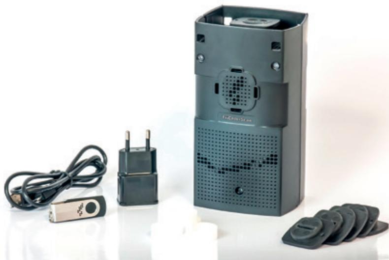
Cifec propose un analyseur in situ et en continu sur 24 h utilisant un capteur nanoporeux breveté spécifique des trichloramines de l'air. Le Trichlorscan est un boîtier portable autonome qui mesure les trichloramines en continu, ainsi que le CO<sub>2</sub>, l'humidité et la température de l'air.
