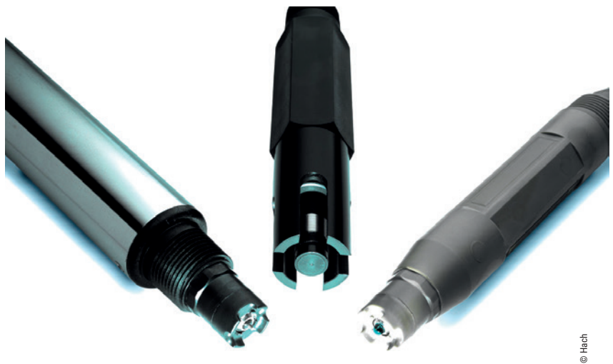
La membrane perforée de la sonde pH 1200-Sensor de Hach, combinée à un électrolyte solide polymérisé, rend l'électrode particulièrement insensible à l'encrassement.
