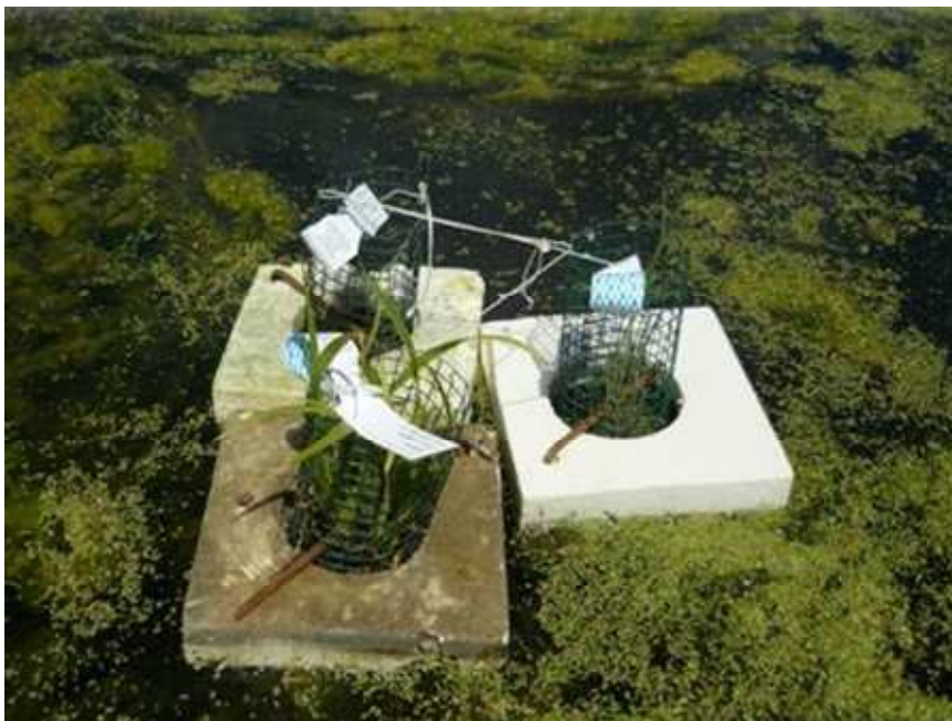
Figure 18. Monitoring in situ par substrats artificiels pour confrontation des données milieu avec les données du modèle
