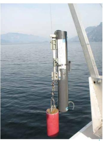
Photo 2 – Bouteille cylindrique à clapet utilisée pour les prélèvements ponctuels : l'envoi d'une masse (appelée messager) le long du câble retenant la bouteille provoque sa fermeture et permet d'échantillonner l'eau à la profondeur souhaitée (© CISALB)
