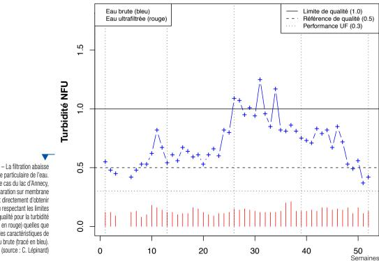
Fig. 2 - La filtration abaisse la charge particulaire de l'eau. Dans le cas du lac d'Annecy. la séparation sur membrane permet directement d'obtenir une eau respectant les limites de qualité pour la turbidité (tracé en rouge) quelles que soient les caractéristiques de l'eau brute (tracé en bleu).
