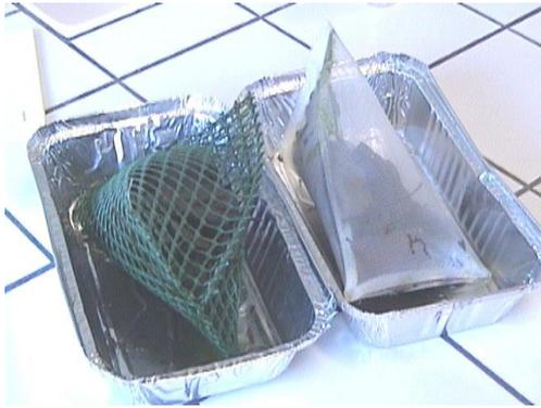
**Figure I.7** Sacs de litière à grosses (à gauche) et à fines mailles (à droite) en forme de tétraèdres. (Source : H. Roussel).
