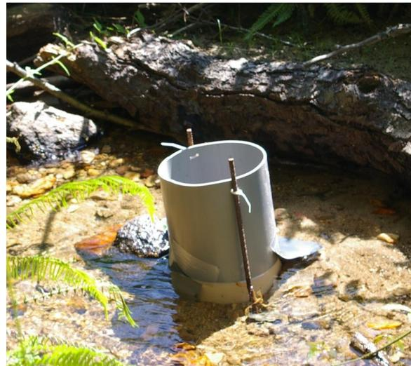
**Figure IV.3** Quantification du remaniement sédimentaire *in situ*. Acquisition de l'image et enceinte.
