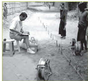
Géophysique (panneau électrique en Afrique)
