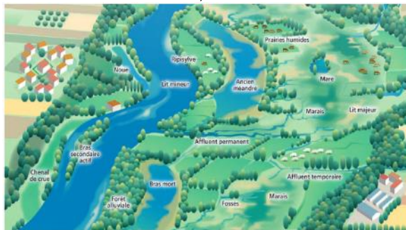
Les principales annexes hydrauliques OFB, 2018
