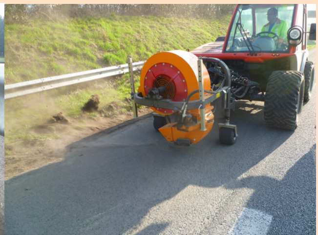
Photos n°15 et 16 : Balayeuse tractée et souffleur sur tracteur de pente (Dir Ouest CEI Loudéac)
