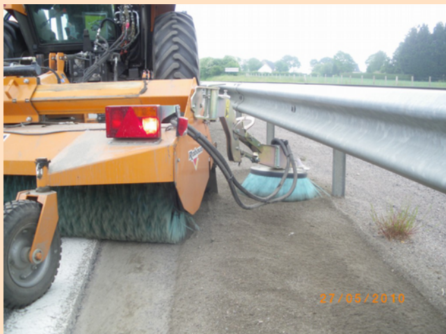
Photos n°15 et 16 : Balayeuse tractée et souffleur sur tracteur de pente (Dir Ouest CEI Loudéac)
