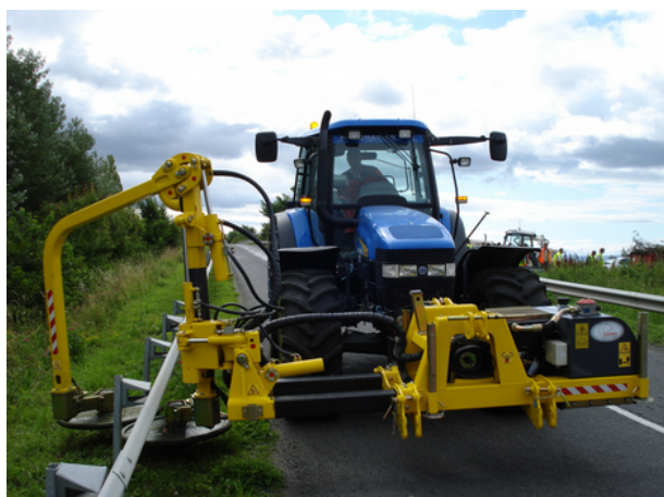
Photo n°27 : Faucheuse sous-glissière 2 bras (DIR Sud Ouest)
