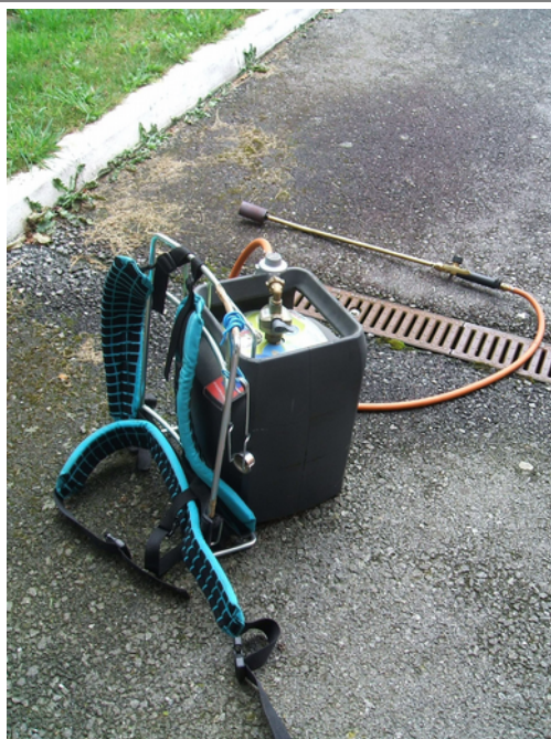
Photo n°28 : Matériel pour désherbage thermique (DIR Ouest)
