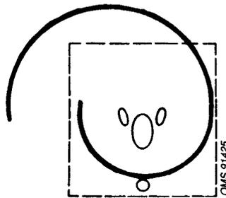
Le trou de défécation doit rester ouvert pour permettre le libre passage de l'air. L'évent doit déboucher à au moins 50 cm au dessus du toit, sauf si celui-ci est conique, auquel cas le tuyau doit arriver à la hauteur du sommet. Des turbulences de l'air dues aux bâtiments environnants, ou d'autres obstructions (arbres), peuvent provoquer une inversion du courant d'air, d'où une mauvaise odeur dans la cabine.
