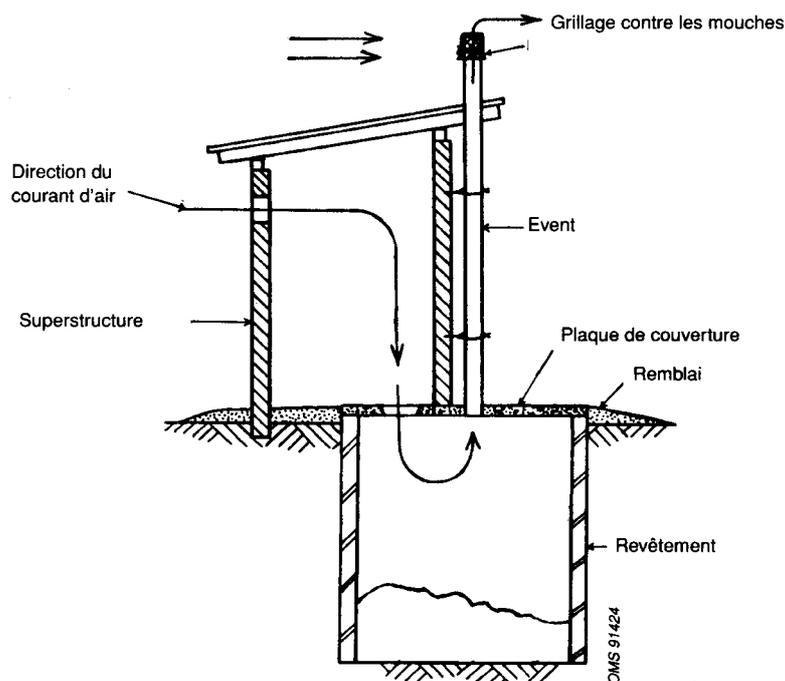
Ce courant d'air permanent élimine les odeurs dues à la décomposition des excréments dans la fosse et décharge les gaz dans l'atmosphère au sommet de l'évent et non dans la cabine. On obtient un courant d'air plus fort en installant la porte de la cabine face au vent dominant. Il est nécessaire de laisser une ouverture au dessus de la porte pour laisser entrer l'air. La surface de cette ouverture doit être au moins égale à trois fois la section de l'évent.
