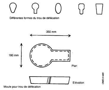
Une largeur maximale de 180 mm et une longueur totale d'au moins 350 mm sont requises. Dans les dalles en béton, le noyau qui forme le trou sera prévu avec une dépouille facilitant son retrait après la coulée.
