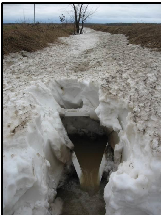
Figure A.5 - Problème de mesure hivernale lors de la fonte de neige sur le site Blanchette le 31 janvier 2013 (Photo : Mikael Guillou).
