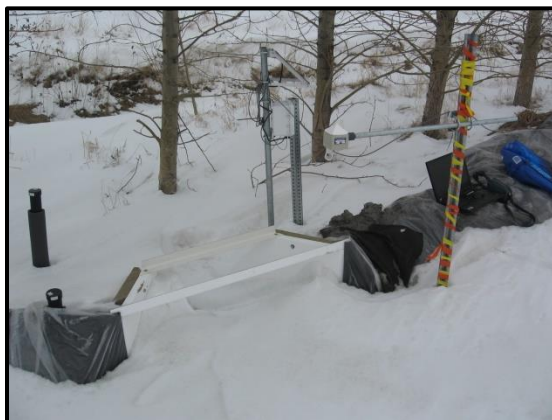
Figure A.4 - Problème de mesure hivernale en présence de glace sur le site Palardy le 15 février 2012 (Photo : Mikael Guillou).
