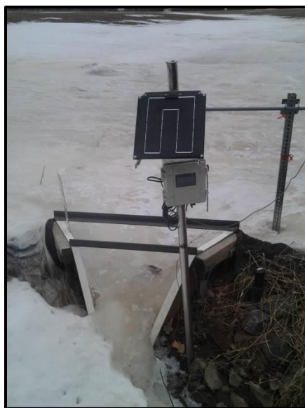
Figure A.3 - Problème de mesure hivernale en présence de glace sur le site Berna le 2 avril 2015 (Photo : Mikael Guillou).
