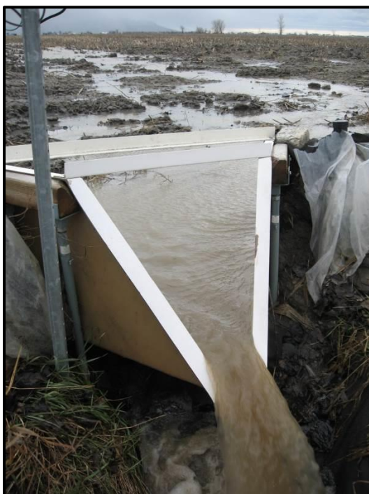
Figure A.8 - Équipement pour la mesure de débit sur le site Palardy le 31 janvier 2013 (Photo : Mikael Guillou).
