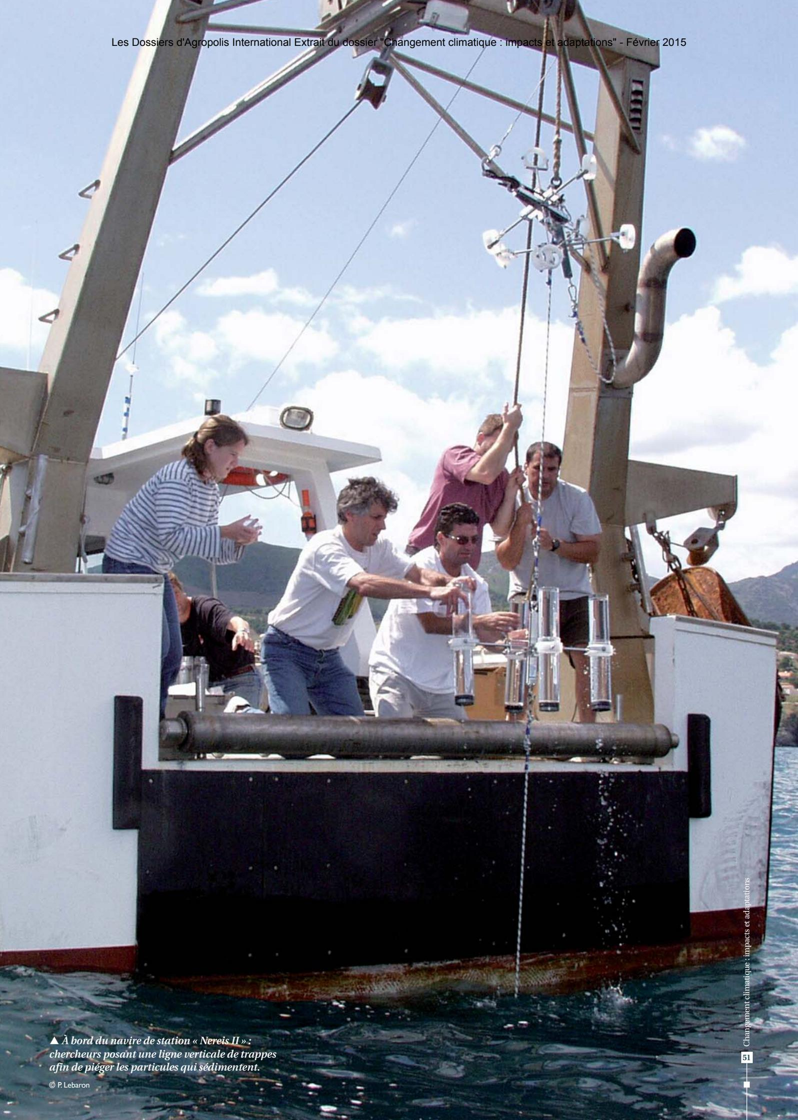
▲ À bord du navire de station « Nereis II » : chercheurs posant une ligne verticale de trappes afin de piéger les particules qui sédimentent.
