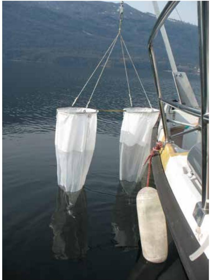
Photo 4 – Filet de vide de maille de 200 µm utilisé pour l'échantillonnage du zooplancton : les prélèvements sont réalisés lors de traits verticaux depuis 50 m de profondeur jusqu'à la surface (© CISALB)
