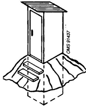
On évitera d'utiliser des remblais de terre sur les sols argileux, car il pourrait y avoir des suintements à la base du remblai faute d'infiltration dans le sol. Le système des fosses surélevées peut être utilisé pour tous les types de latrines. Ces latrines sont d'usage courant lorsque la nappe est voisine de la surface du sol.
