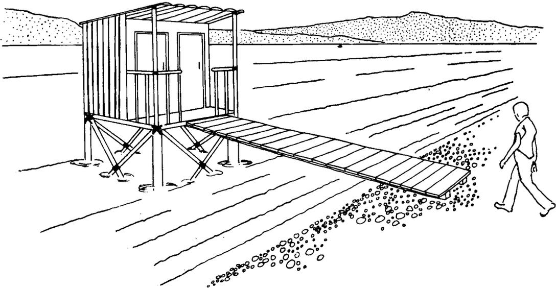
Un trou de défécation est aménagé dans le plancher. Il permet aux excréta de tomber directement dans l'eau. Un tuyau de chute peut être installé entre le plancher et l'eau. Il ne faut en aucun cas installer ce type de latrines quand on peut installer des latrines à fosse. Néanmoins elles peuvent constituer le seul moyen d'assainissement utilisable pour des populations vivant sur une terre inondée en permanence ou selon la saison.
