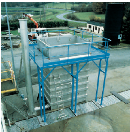
El nuevo piloto Pulsator-Degrémont para entrenarse en la explotación de decantadores a velo de lodo
