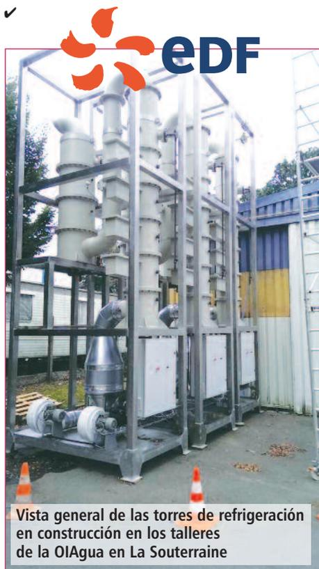
Vista general de las torres de refrigeración en construcción en los talleres de la OIAgua en La Souterraine
